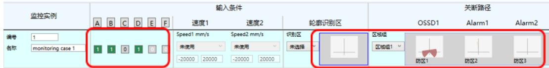
图 4-5 静态控制输入配置示例
